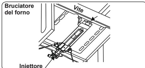
Rimuovere gli iniettori tramite una chiave da 7 mm e sostituirli con quelli del set
